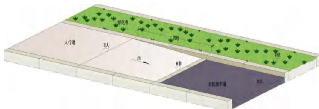
单面坡式残疾人坡道轴侧图
