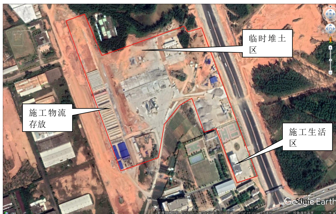
图 2-15 施工临时工程区平面布置图
